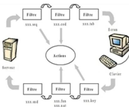
Le cycle d'émulation montre que le flux de données passe au travers de différents filtres qui agissent ou non sur les données en fonction de leur nature et du paramétrage de ces filtres.
