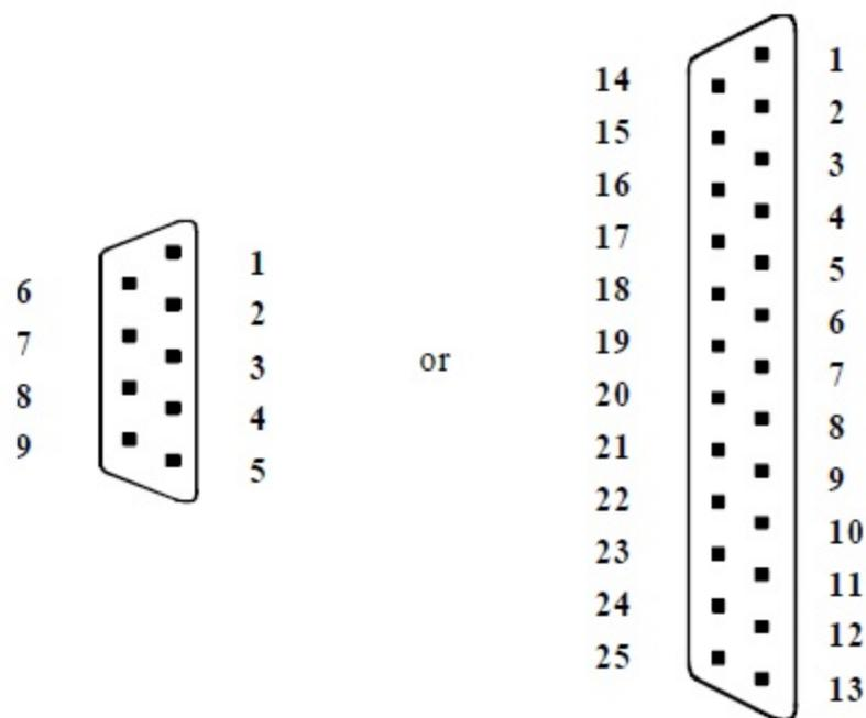
Chaque broche d'une prise RS232 (9 ou 25 points) a une signification. Vis-à-vis de la norme série RS-232, les équipements informatiques sont classés en deux catégories : terminaux et ordinateurs hôtes.
