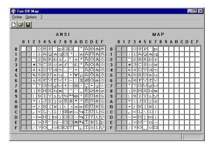
Le tableau de gauche contient tous les caractères disponibles sur le PC (ASCII et ASCII étendu). Le tableau de droite doit contenir les mêmes caractères mais avec les positions qui correspondent à la notation utilisée par le SGBD de la machine UNIX. Les 128 premières positions du tableau de droite sont déjà affectées car se sont les seules qui soient constantes d'un système à l'autre.
