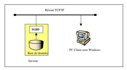
Un PC "client" dispose d'une application de gestion traditionnelle en mode graphique. Les données sont centralisées sur un serveur UNIX et sont gérées par un Système de Gestion de Base de Données Relationnel (SGBDR). Pour extraire ou pour mettre à jour des données, le client transmet une requête SQL au serveur qui l'exécute et retourne la réponse au client par l'intermédiaire du réseau.
